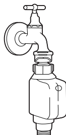
manguera de suministro de seguridad
