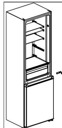
6) Coloque el conjunto de bisagras con un destornillador. Coloque el conjunto de bisagra inferior en el lado izquierdo del electrodoméstico con un destornillador.
