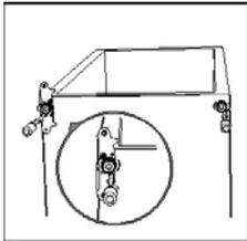
9. Coloque la bisagra del medio en posición de 180 grados, luego transfírala a la posición correcta en la izquierda. Coloque el pasador de la bisagra central en el orificio superior de la puerta inferior, entonces apriete los tornillos.
