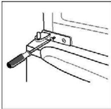
10. Coloque la puerta superior de nuevo. Asegúrese de que la puerta esté alineada horizontal y verticalmente, de modo que los sellos estén cerrados por todos los lados antes de apretar la bisagra superior. Entonces inserte la bisagra y el tornillo en la parte delantera de la unidad.
