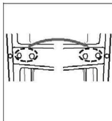
6. Desatornille la bisagra inferior. A continuación, retire las patas ajustables de los dos lados.
