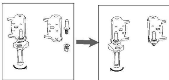
8. Vuelva a colocar el soporte de montaje del pasador de la bisagra inferior. Reemplace ambas patas ajustables. Transfiera la puerta inferior a la posición correcta.
