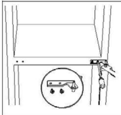
3. Retire el pasador con un destornillador y dele la vuelta al soporte de la bisagra. Entonces vuelva a colocar el pasador de la bisagra del soporte.
