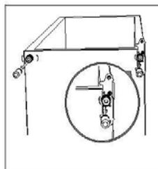
7. Destornille y retire el pasador de la bisagra inferior, gire el soporte y reemplácelo.
